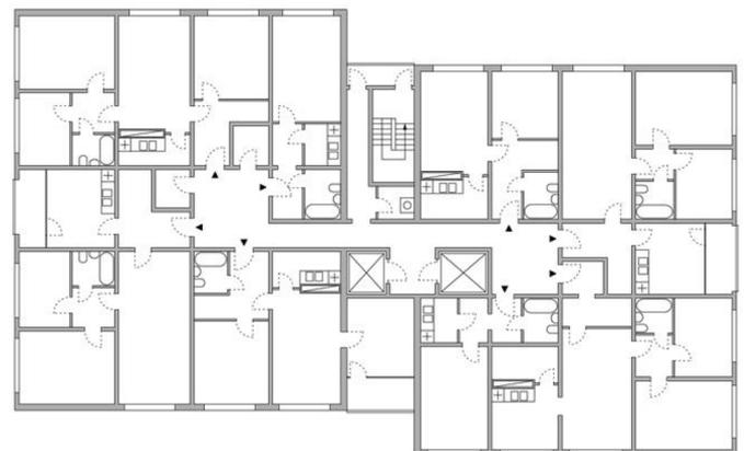
Abb. 24: Grundriss am Beispiel WHH-GT 18 (1978), WBM
